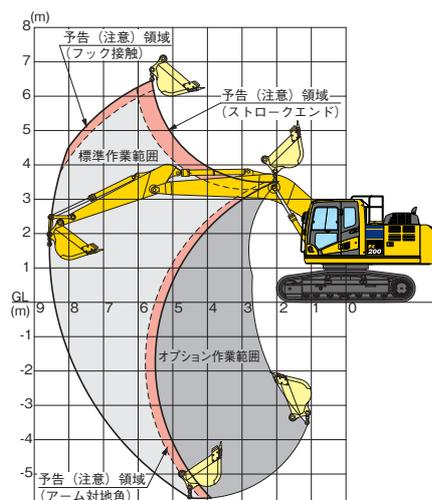
※アームシリンダボトム側落下防止弁 (オプション) 装着により、 の範囲も吊り作業が可能になります。
